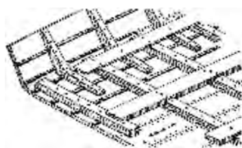
Colocação das primeiras meias cavernas em L e travessões de reforço
