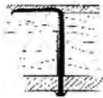
Exemplo de pregadura de ferro entre cinta, forro e braço da baliza, encontrado no achado de Blackfriars, Séc. II dC
