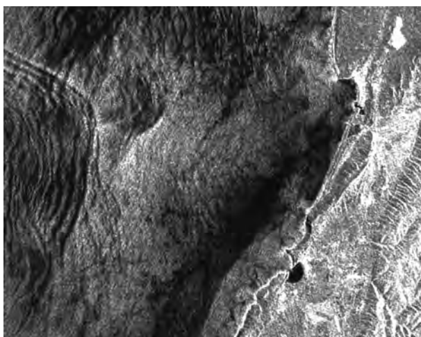
Fig.1 A modelação da textura da superfície do mar pelas ondas internas é de natureza muito complexa e variada. As micro-ondas não penetram a superfície do mar (nem do solo) pelo que os padrões observados na imagem radar devem-se a variações da sua rugosidade. Enquanto que nas regiões terrestres a luminosidade impressa na imagem SAR é função do declive da superfície (que pode ser favorável, ou não, para uma retro-difusão na direcção do satélite), na água são as interacções entre as ondas capilares à superfície com os diferentes processos hidrodinâmicos que moldam a sua rugosidade. Esta imagem corresponde a uma subsecção da frame 2817, obtida pelo satélite ERS1 em 22 JUL 1994, mostrando a região costeira da Nazaré. Nela são visíveis a enseada da Nazaré (a Norte) e a enseada de S. Martinho do Porto (mais a Sul). Ao largo, diferentes assinaturas de ondas internas a propagarem-se na direcção da costa.
