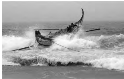
A vantagem de um fundo chato e curvo, e de uma proa levantada, quando o barco entra no oceano para a faina, demonstrada por uma “barca de mar” da Costa de Aveiro
