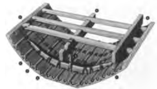
Corte transversal do barco de Khurfu, c. 2560 aC
