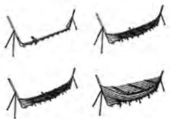
Construção mista, com assentamento inicial da quilha, rodas e tabuado do costado, e só depois as cavernas, como demonstrado na Holanda. Ver trabalho de Van de Mortel
