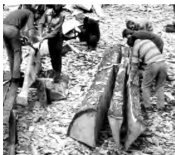
A técnica mais antiga de abrir troncos, apenas com machado, mão e cunhas de madeira dura
