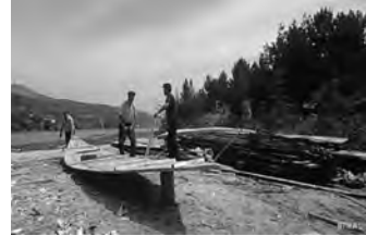
Passagem do tabuado do fundo para o picadeiro, para lhe dar uma forma curva
